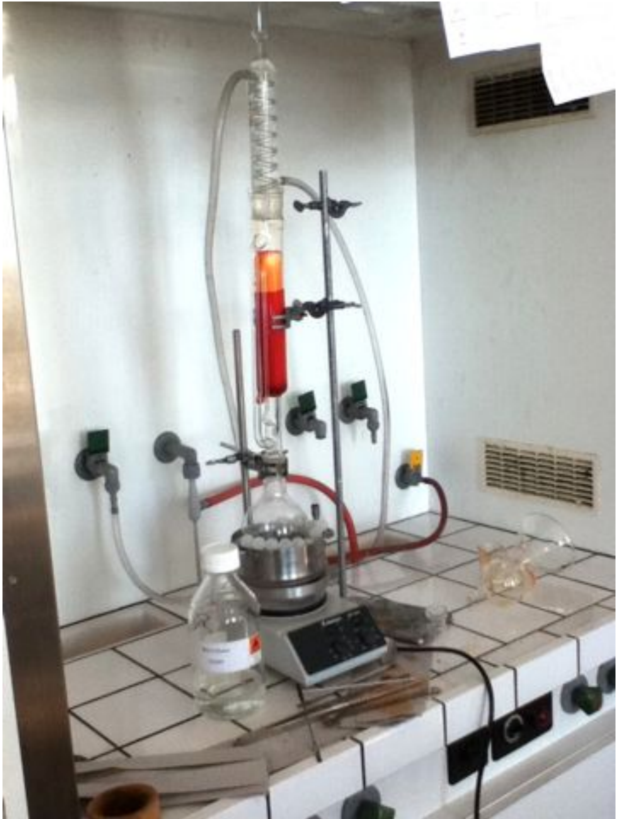
Abb. 8: Soxhlett-Apperatur mit Chili-Ethanol-Gemisch
