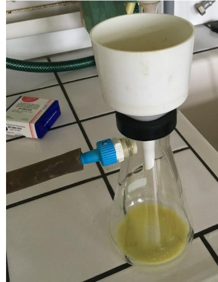
Abbildung 10: Saugflasche mit Nutsche; darin filtrierter Ingwersaft; auf der linken Seite der Schlauch zum Wasserstrahl, damit in der Falsche Unterdruck erzeugt werden konnte
